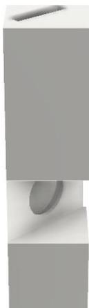
Figura 4.1. Soporte de PLA para medidas de fluorescencia 3D a 45°.
