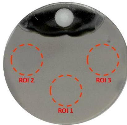
Figura 3.1. Disco de  $\alpha$ -Ti-6Al-4V con los ROI.
