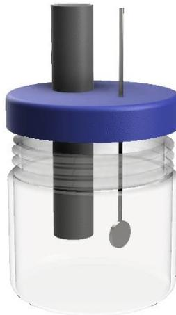
*Figura 5.1. Dispositivo para anodizado electroquímico.*
