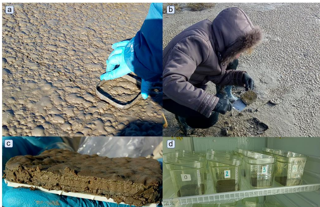
Fig. 2.1. Recolección de muestras de matas microbianas para ensayos de remoción de metales. a) Corte de la mata microbiana con un molde cortante. b) Separación de la muestra con espátula. c) Mata microbiana sobre una rejilla plástica. d) Matas microbianas en contenedores acrílicos en cámara de cultivo durante el período de aclimatación.
