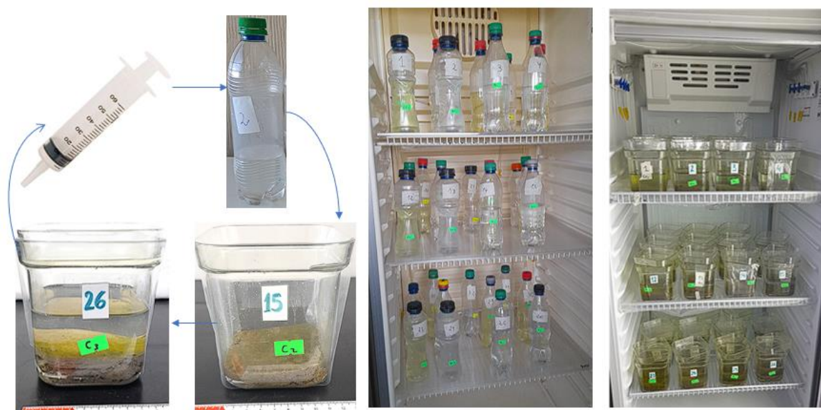
Fig. 4.5. Jeringa y botellas utilizadas para simular el efecto de marea en las matas microbianas. Soluciones en heladera y matas microbianas en cámara de cultivo.
