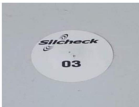
**Figura 15.** Etiqueta Rfid adherida al silobolsa
