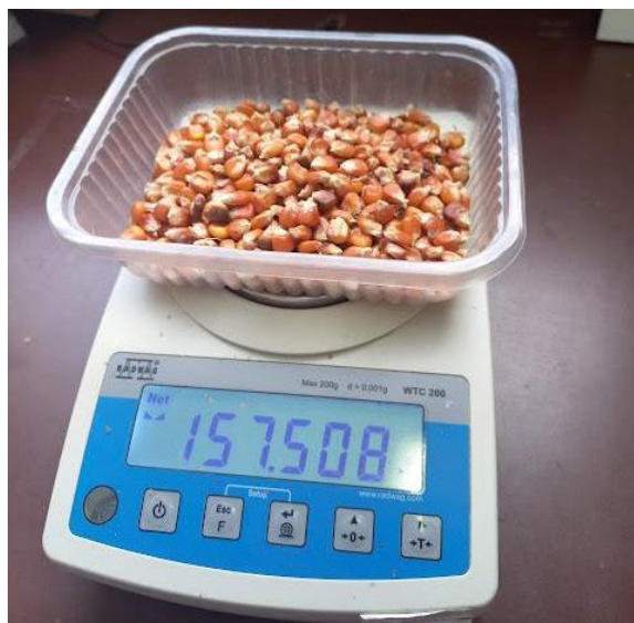
Figura 11. Balanza digital utilizada para pesar los granos de maíz.
