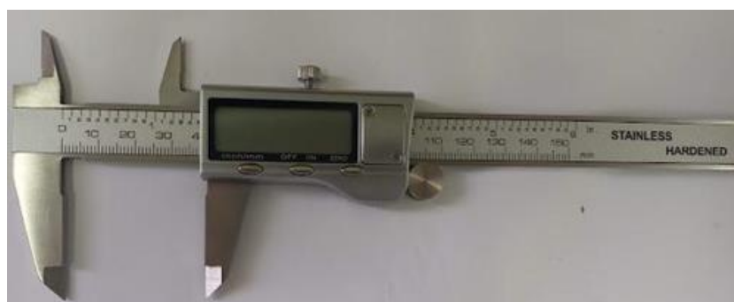
Figura 10: Calibre digital utilizado para medir el diámetro de las espigas.
