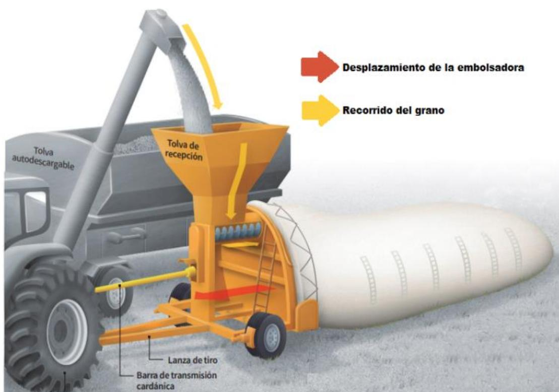
Al llegar al final de la bolsa, posee un indicador de “fin de bolsa”, que nos orienta para no arrojar más granos. En general son 4-5 pliegues, se avanza con el tractor separando la embolsadora de la bolsa y se procede a cerrarla, enrollandola y tapando con tierra.
