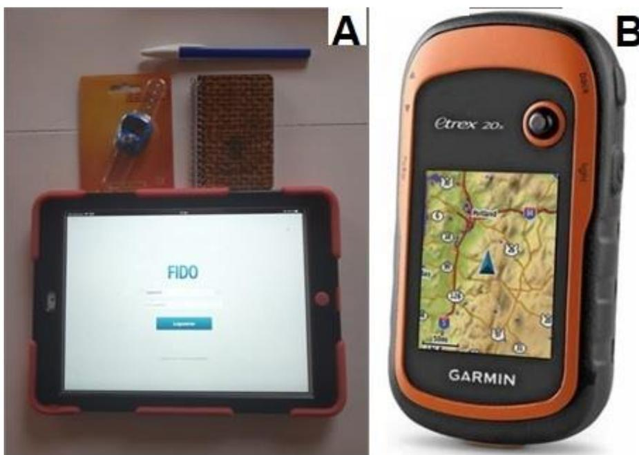
Figura 9: Instrumentos utilizados para la toma de datos. A: Tablet con software FIDO, contador y libreta; B: Dispositivo de posicionamiento global (GPS).
