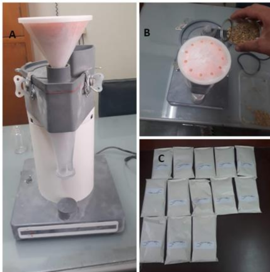
Figura 7. Molino ciclónico Udy con el que se realizó la molienda individual de cada muestra (A y B) y bolsas conteniendo las muestras de grano (C).
