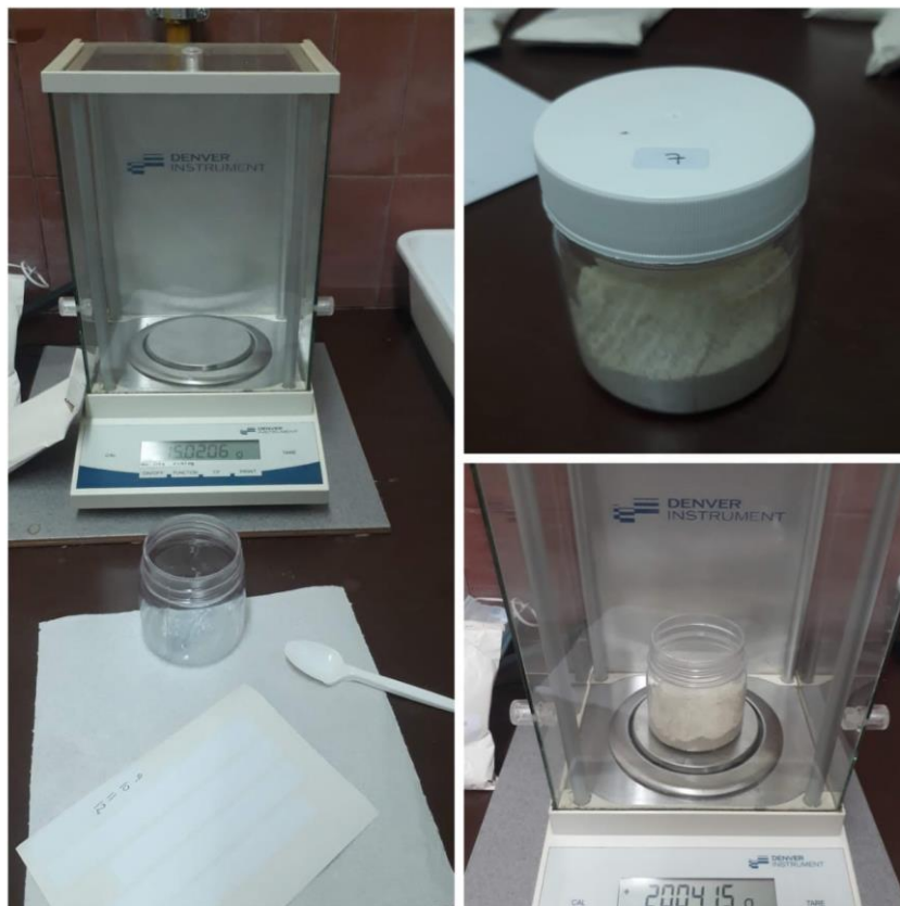
Figura 8. Balanza analítica en la que se pesaron las muestras molidas. Antes del pesaje se realizó la tara de cada recipiente.
