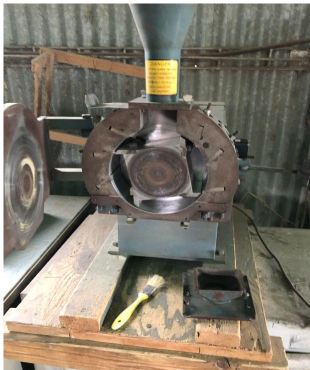
Figura 9: Vista del molino de Wiley utilizado para procesar las muestras de alimento
