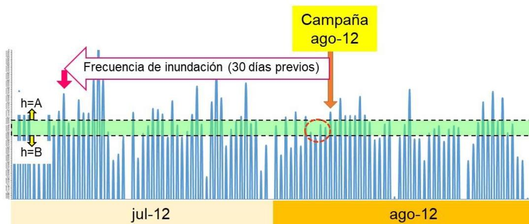
**Figura 7.** Esquema del criterio para el cálculo de la frecuencia de inundación y los días de exposición, donde h=A: altura de marea que cubre la zona A, h=B: altura de marea que cubre la zona B.
