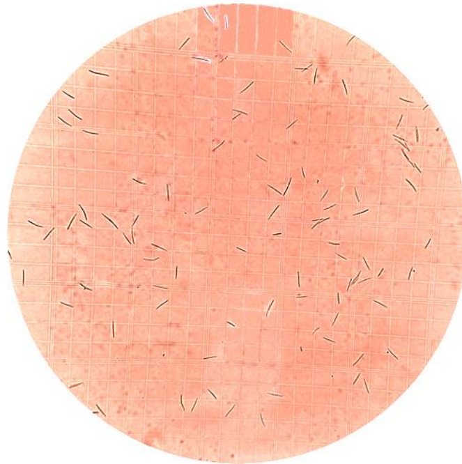
Figura 7: Cuadrícula de la cámara de Neubauer vista bajo microscopio, empleada para el recuento preciso de conidios de Septoria convolvuli en la preparación de la suspensión a ser inoculada.
