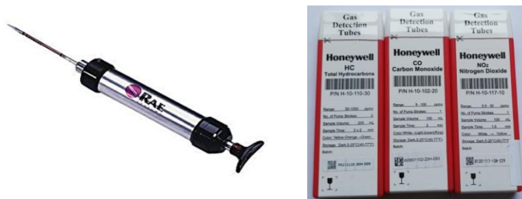
Figura 6.1. Bomba manual marca RAE (LP-1200) y tubos colorimétricos marca Honeywell. Fuente propia
