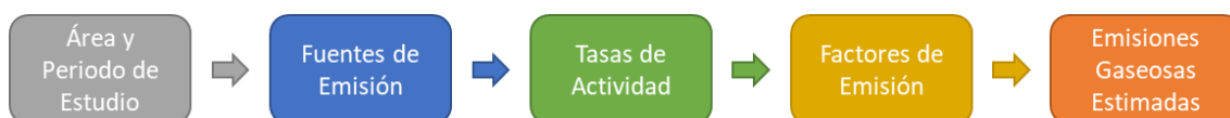
Figura 2.1. Camino lógico para la confección de un inventario de emisiones gaseosas. Elaboración propia.
