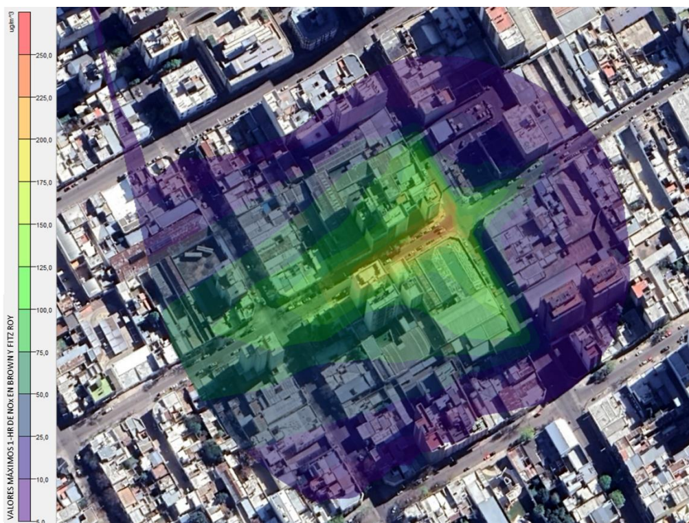
Figura 6.10. Gráfica de dispersión de NOx en la intersección de Brown y Fitz Roy en el momento en que se detectó el mayor nivel de concentración: 220.37 [ \mu\text{g}/\text{m}^3 ] el 10/05/2022 por la mañana (8 a.m.).
