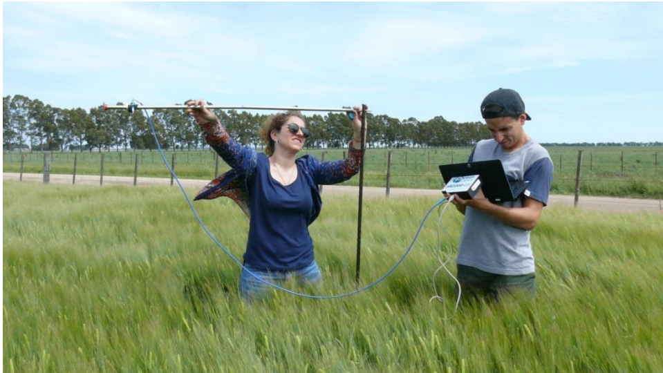
Figura 1. Medición con espectrorradiómetro para cultivo de cebada. Tres Arroyos, 15 de noviembre de 2019
