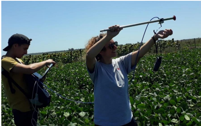
Figura 3. Calibración del espectrorradiómetro en cultivo de soja. Tres Arroyos, 11 de febrero de 2020
