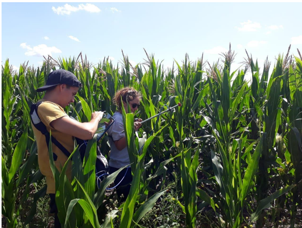
Figura 4. Calibración del espectrorradiómetro en cultivo de maíz. Tres Arroyos, 11 de febrero de 2020
