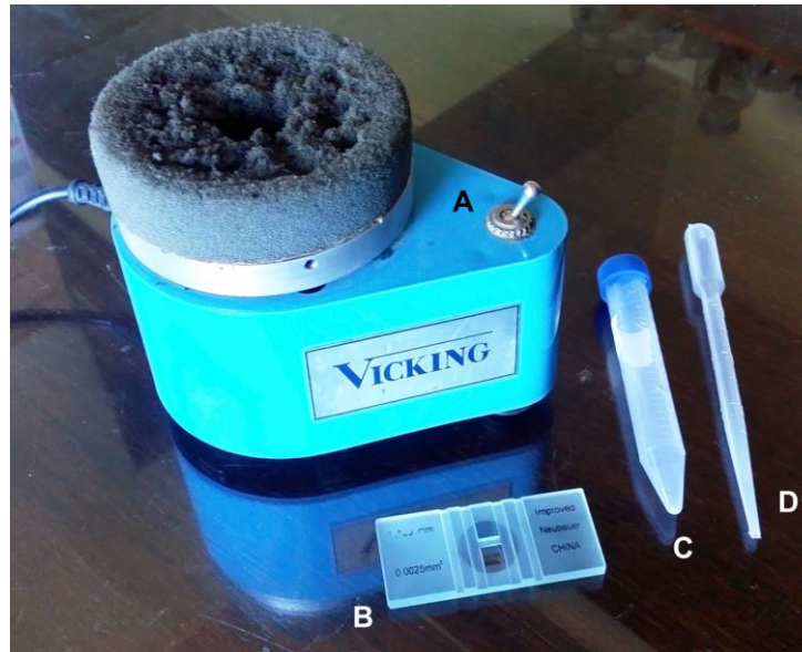
Figura 4.1: Elementos de laboratorio utilizados. A: vórtex; B: cámara de Neubauer; C: tubo Falcon de 15 ml; D: pipeta Pasteur.
