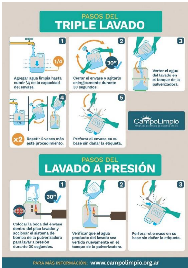
Figura 16. Pasos del triple lavado y del lavado a presión. Fuente: CampoLimpio, 2021a.
