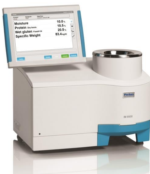
Figura 12. Espectrofotómetro Analizador para granos enteros NIR, Inframatic 9500 para la determinación de humedad, proteína, materia grasa y gluten en cereales
