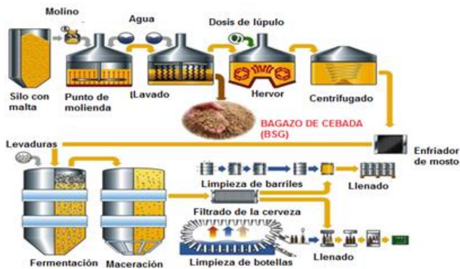
Fig. 4.4. Proceso de fabricación de la cerveza donde se observan las distintas etapas y la generación del BSG (Lynch et al., 2016).
