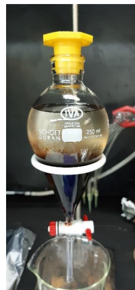
Fig. MyM.5. Separación del medio desfenolizado (fase inferior) del acetato de etilo (fase superior).
