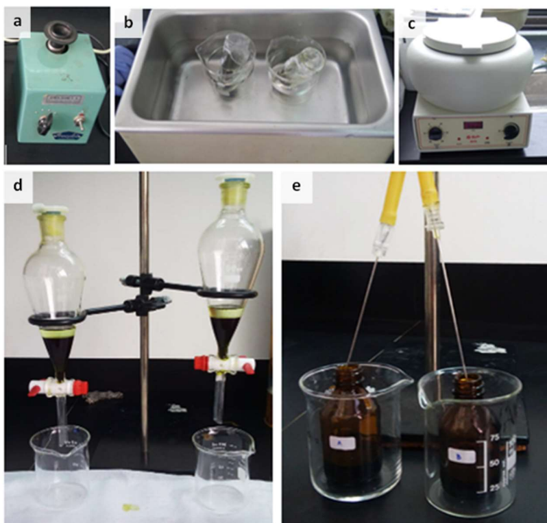
Fig 2.7. Extracción de lípidos totales. a) Vortex. b) Baño ultrasonido. c) Centrifuga de mesada. d) Ampollas de decantación con separación de fases. La fase inferior contiene los extractos lipídicos. e) Secado de las fracciones lipídicas bajo atmósfera de nitrógeno.
