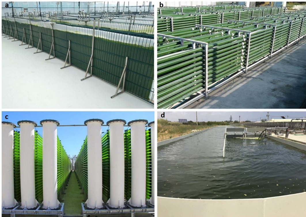
Figura 1.5. Diferentes sistemas de cultivo utilizados actualmente para la producción industrial de biomasa de microalgas. a) Fotobiorreactor de panel plano de 1 m 3 . b) Fotobiorreactor tubular de 2,5 m 3 . c) Fotobiorreactor tubular de 100 m 3 . d) Raceway de 200 m 3 (Fuente: Pereira et al., 2018).
