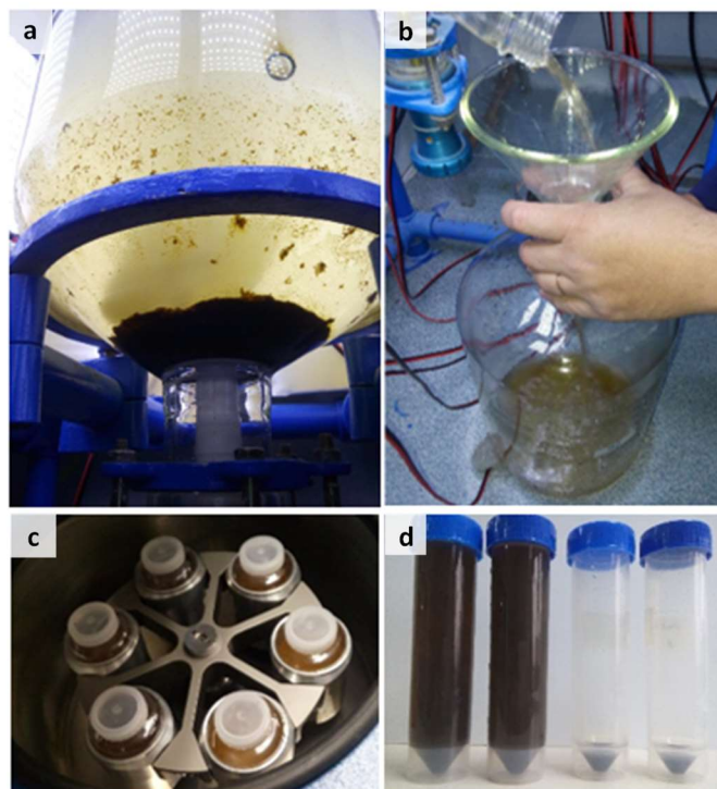
Figura 2.6. Cosecha de la biomasa microalgal producida en fotobiorreactor. a) Cultivo donde se observan las microalgas autofloculadas y el sobrenadante. b) Recolección de la biomasa decantada en recipientes de vidrio. c) Centrífuga Presvac . d) Tubos de centrifuga antes (tubos de la izquierda) y después (tubos de la derecha con pellet) del último paso de centrifugación con centrifuga de mesada Rolco.
