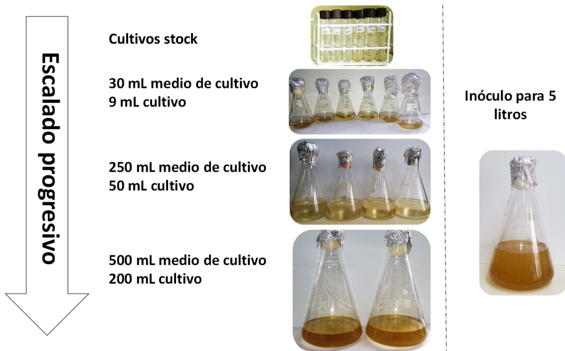
Figura 2.5 Obtención de inóculo para cultivo en fotobiorreactor. Escalado progresivo realizado a partir de los cultivos stock para obtener un inóculo de células suficiente para iniciar un cultivo en fotobiorreactor.
