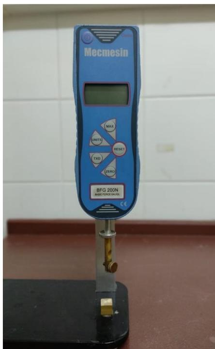
Figura 2.10. Dinamómetro utilizado en los ensayos de fuerza de adherencia.
