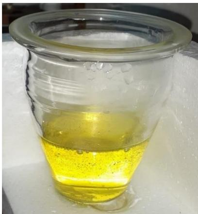
Fig. 6.7. Formación de ácido pertitánico durante la oxidación química de la aleación Ti-6Al-4V en solución de  $H_2O_2$ .
