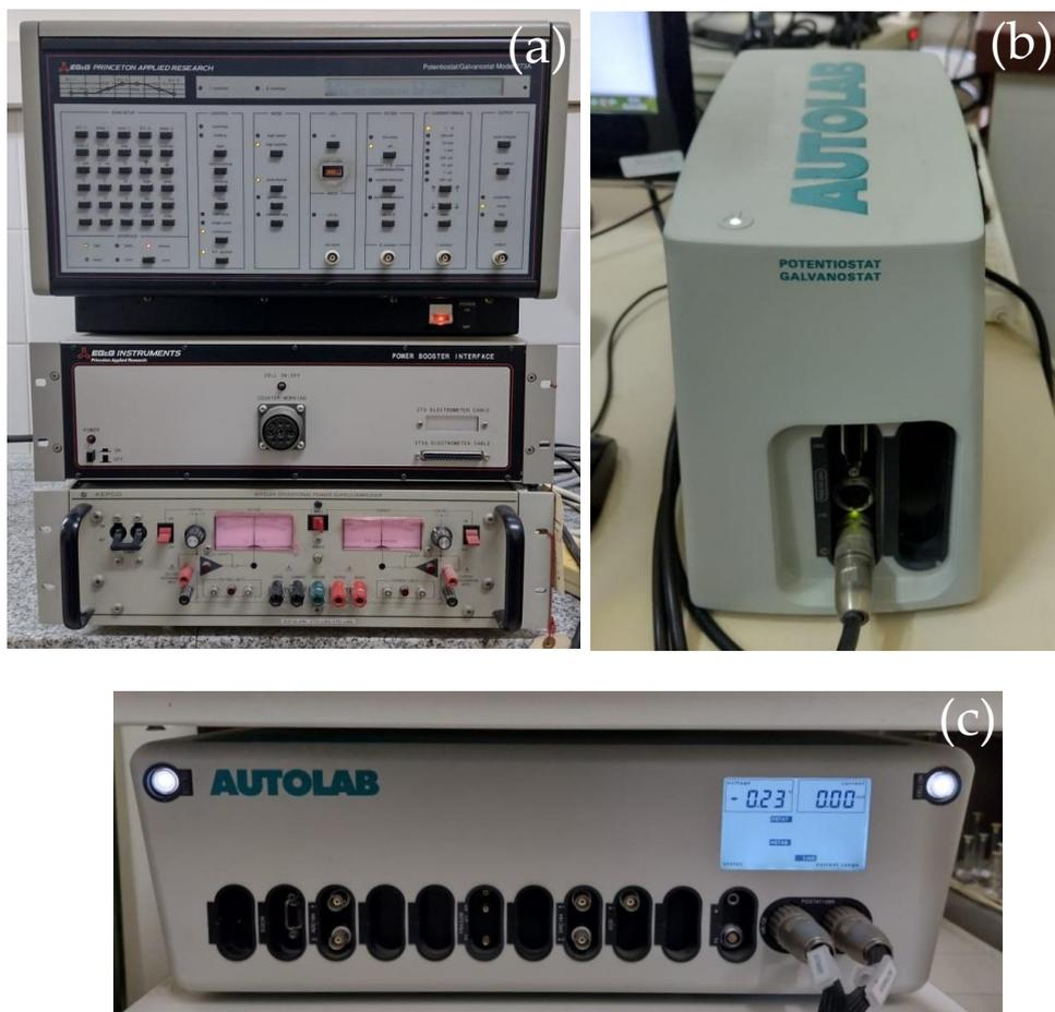
Figura 2.8. Potenciostatos-Galvanostatos empleados en los ensayos electroquímicos: (a) PAR (Princeton Applied Research) modelo 273 A, (b) Autolab/PGSTAT204 y (c) Autolab/PGSTAT128N.
