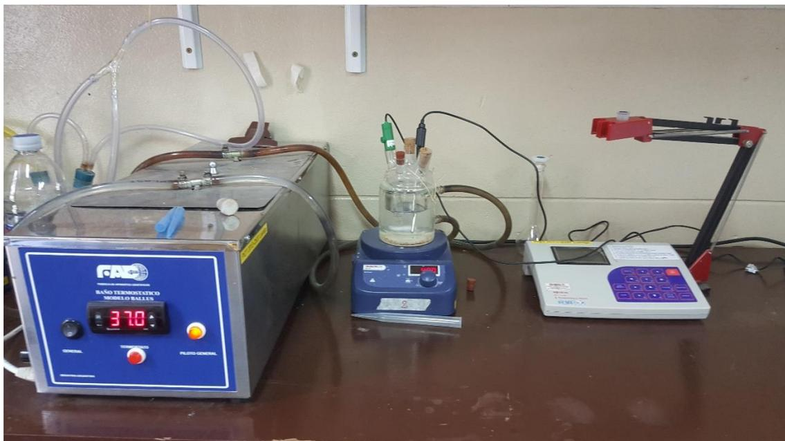
Figura 2.1. Termostato Ballus con agitador Dragon Lab y pHímetro ADWA AD1030
