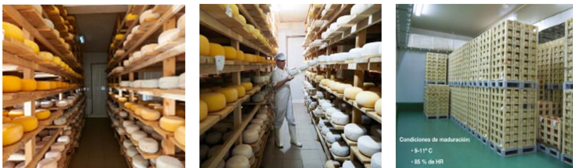
Figura 2.4. Cámaras de maduración de quesos (9-11°C y 85% humedad).
