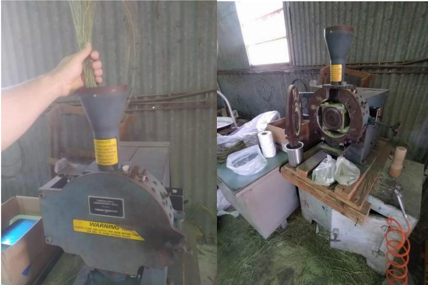
Imagen 4. Molido de muestras de forraje utilizando molino Wiley (Thomas Wiley Scientific, Swedesboro, NJ. USA).
