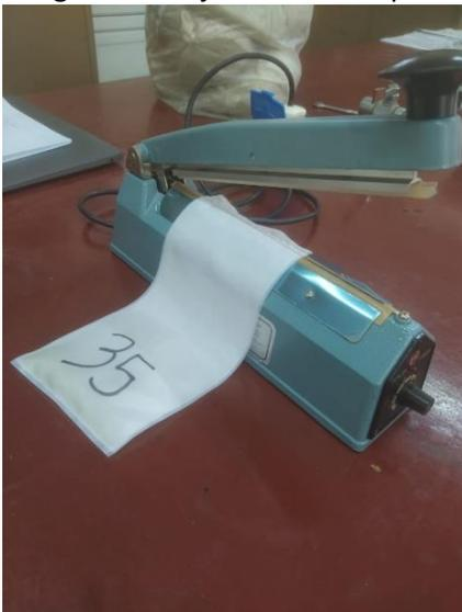
Imagen 6. Sellado con calor para evitar pérdidas de material durante la incubación.
