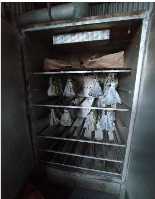
Imagen 12. Bolsas colocadas en estufa a 60°C hasta peso constante.
