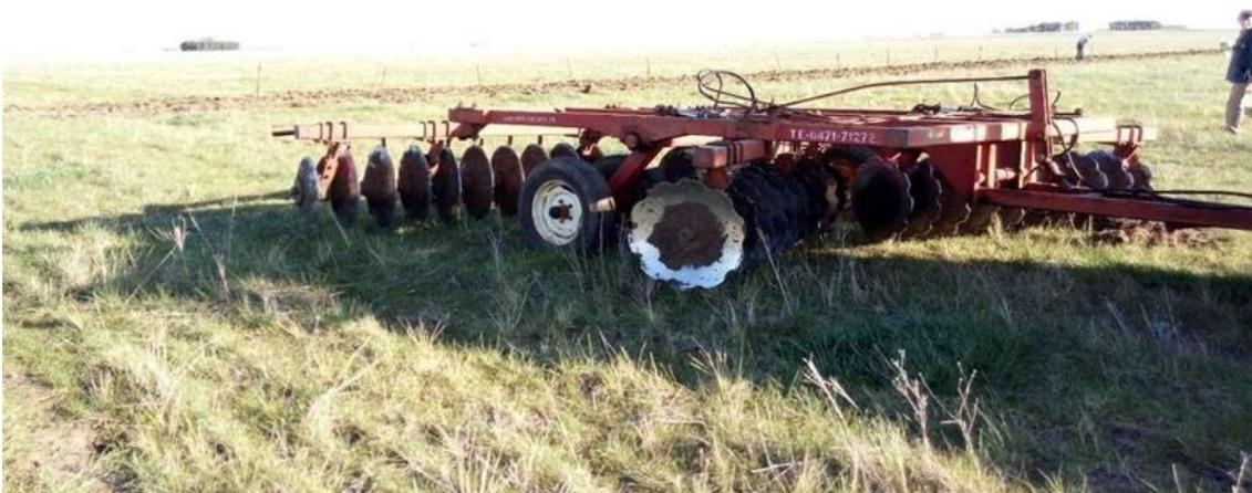
**Figura 11.** Rastra de disco, utilizada para la labor de preparación del sitio 2 de plantación.
