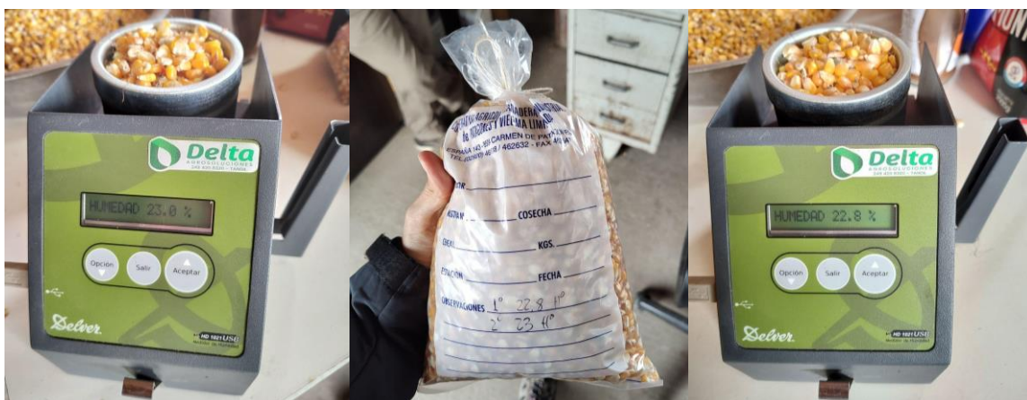
Figura 37. Medición de humedad en la Cooperativa Agrícola y Ganadera de Patagones y Viedma.
