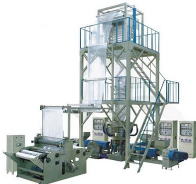
Figura 2.6 Fotografía de un sistema de soplado a escala semi-industrial real (Battenfeld BFA-UNI-EX1-60/BK 120-300/1300).
