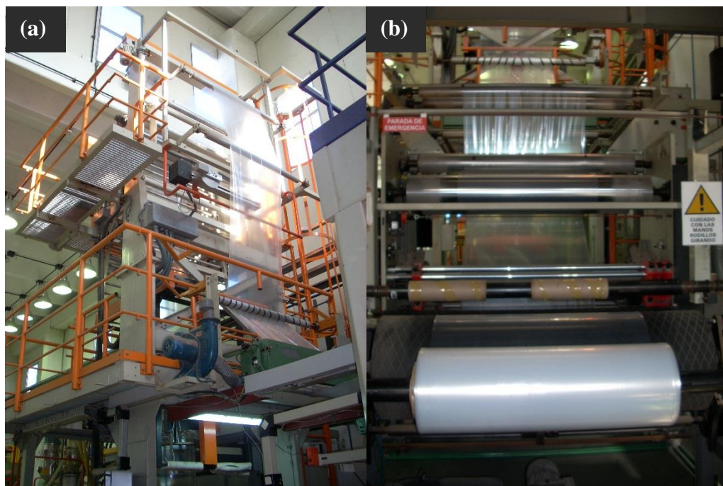
Figura 5.6 (a) Sistema de rodillos guías (calandra de enrollado); (b) Bobina de almacenamiento.
