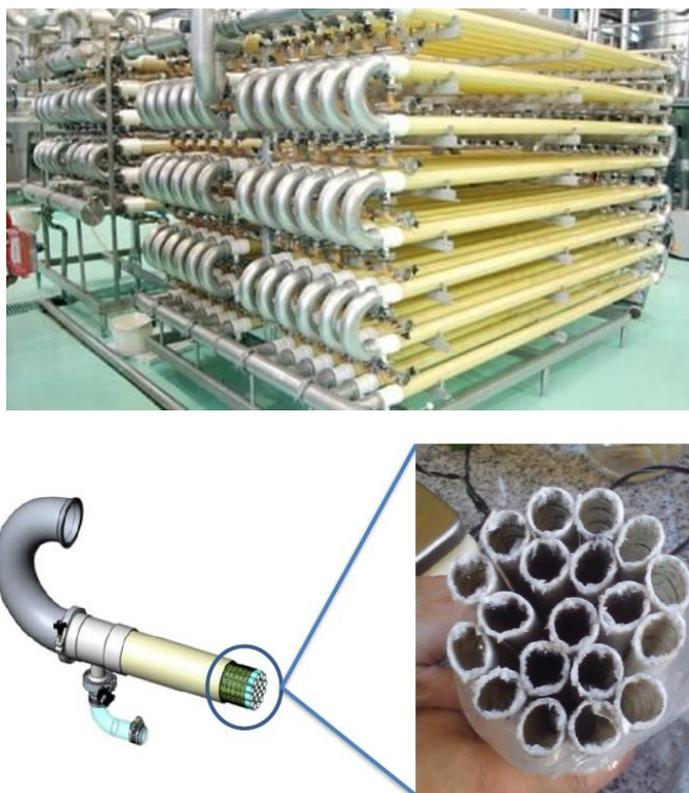
**Figura 5** Proceso de ultrafiltración con membranas de PVDF. Arriba: Imagen del proceso de ultrafiltración. Abajo, recorte de un módulo tubular de usado para la clarificación de jugo de manzana. Fotos tomadas de Tarifa, 2017.
