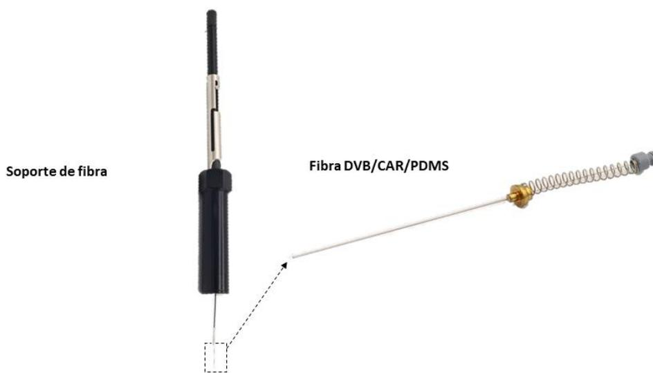
**Figura 36** Soporte de fibra y la fibra de DVB/CAR/PDMS empleada para el método de HS/SPME.
