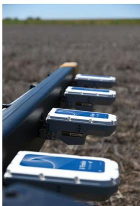
Figura 39. Sensores de lecturas NDVI instalados sobre botalón (imagen ilustrativa obtenida WeedSeeker 2 )
