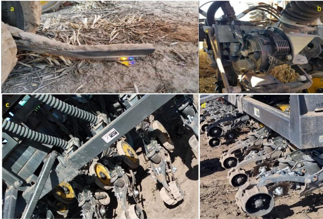
*Figura 37. Vista de un sensor SmartFirmer (a), de un dosificador variable (b) y el sistema deltaforce (c y d), instalados en la sembradora de grano grueso marca ERCA.*
