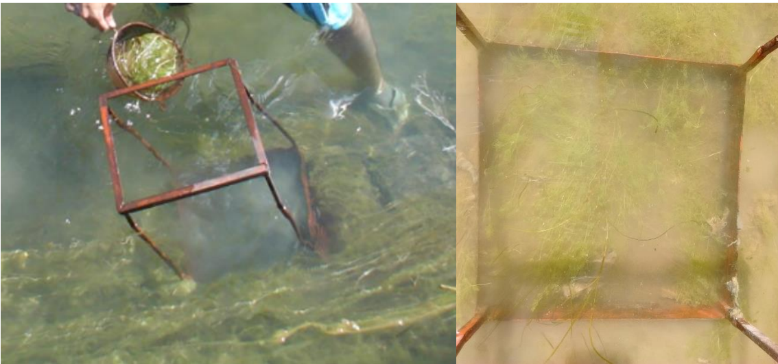
Figura 4.2. Muestreador de vegetación acuática sumergida utilizado en canales de riego entre 2014 y 2019.
