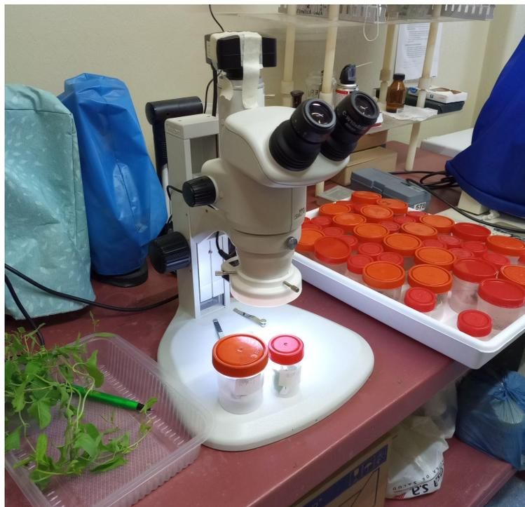
Figura 13: Lupa Nikon SMZ 745T utilizada en la medición.
