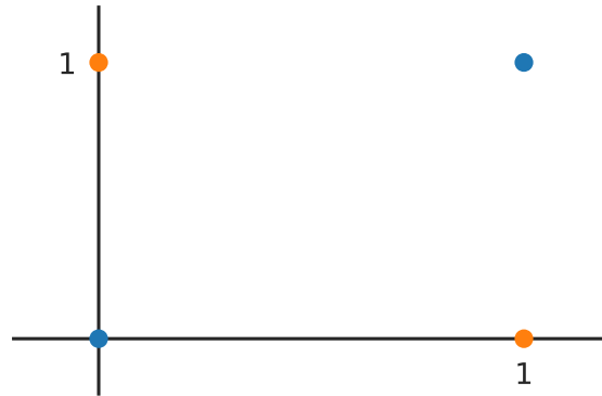
Figura 2.4: Valores de verdad dados por una función XOR representados en diferentes colores, con Azul = Falso . Los ejes representan las dos dimensiones (entradas) a la operación lógica, pudiendo tomar los valores 0 = Falso y 1 = Verdadero . Nótese la imposibilidad de separar el espacio de acuerdo a los valores de verdad de salida mediante una única línea.
