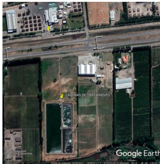
Figura 2.1: Vista aérea del predio en la localidad de Villa Regina, donde se encuentra el sistema de tratamiento de efluentes industriales por lagunaje.
