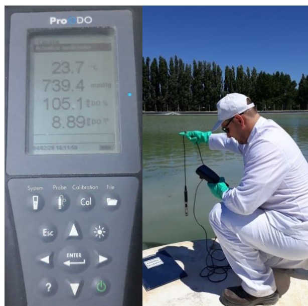
Figura 2.6. Medición de parámetros críticos en las lagunas de tratamiento.
