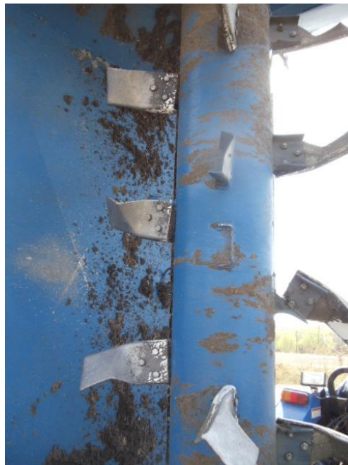
Figura 3.28: Rotura de paletas del rotovator.
