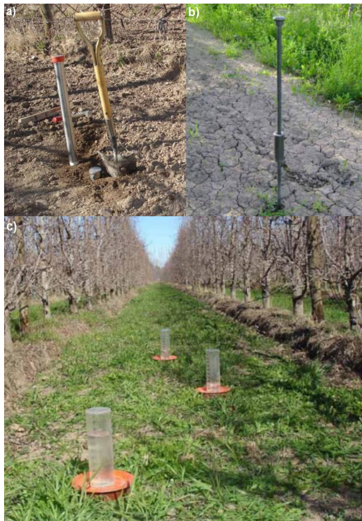
Figura 4.3: Extracción de muestra para determinar la densidad aparente (a), determinación de penetrometría (b) y determinación de infiltración básica (c).
