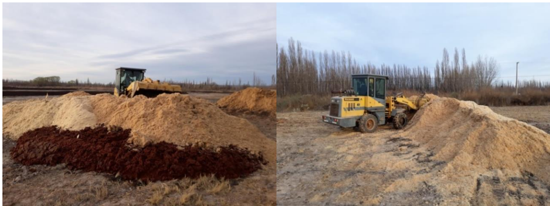
Figura 3.12: Mezclado de pilas de orujo de manzana con material estructurante.
