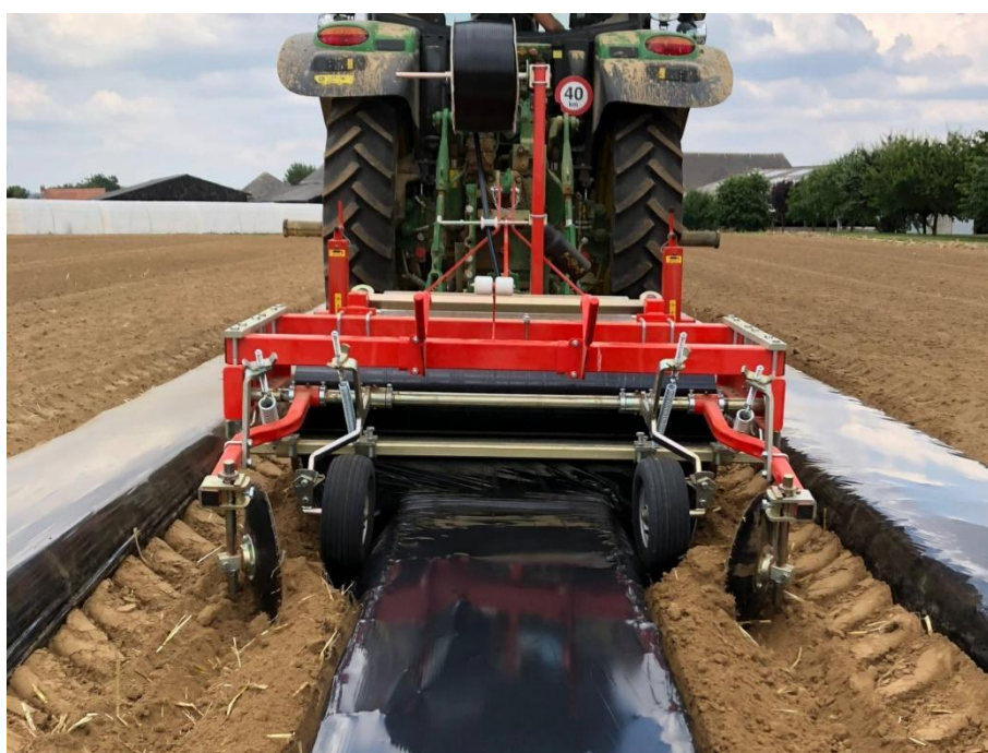
Figura II.3. Máquina acolchadora durante la colocación en campo del mulch plástico. Fuente: www.checchiemagli.com
