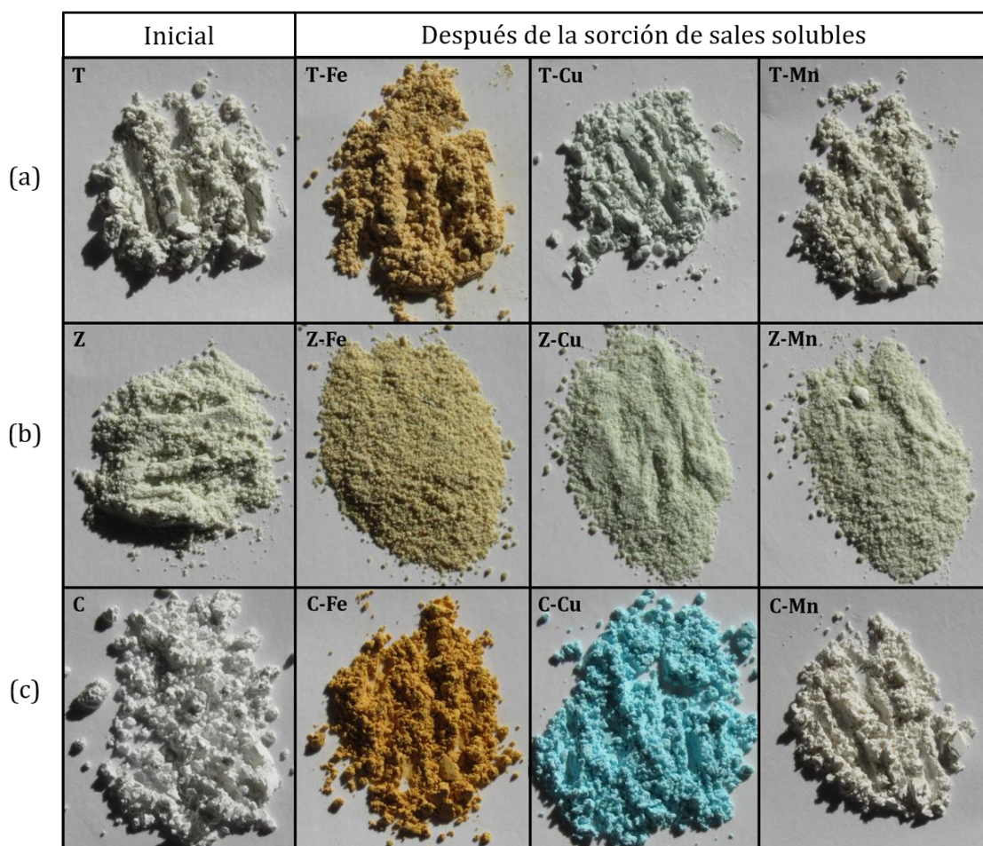
Figura IV.11. Fotografías de las partículas minerales antes y después de los ensayos de sorción de sales solubles de Fe, Cu y Mn: (a) talco, (b) zeolita y (c) carbonato de calcio.
