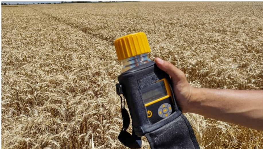
Figura 19: Humedímetro John Deere SW5300 utilizado en Lote 10 del campo de Pehuajó.
