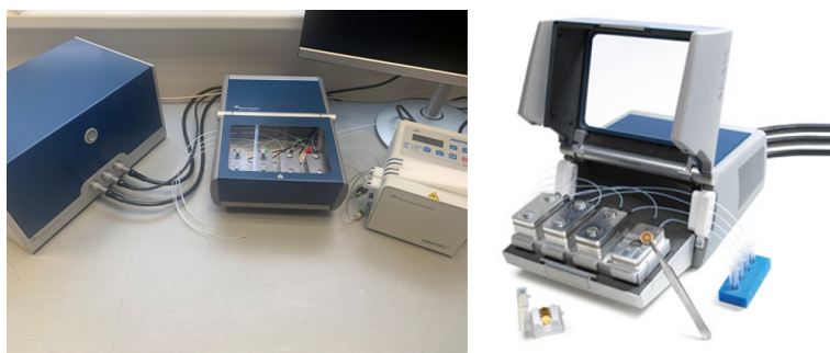
Figura 2.9: Equipo QSense Analyzer conectado a la bomba peristáltica para circulación de las soluciones, al lado el equipo desarmado mostrando las cuatro balanzas y los cristales de cuarzo
