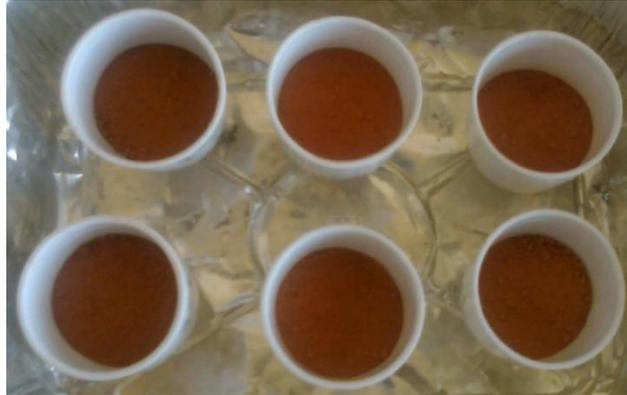
*Figura 8. Resultado de muestras de suelo con calcinación en mufla a 800°C en las que se determinó MO por pérdida de peso.*
