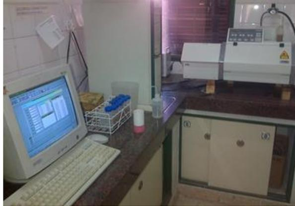
Figura 23. Equipo analizador de partículas determinación (Laser Particle Sizer "analysette 22" Fritsch Gimbft).
