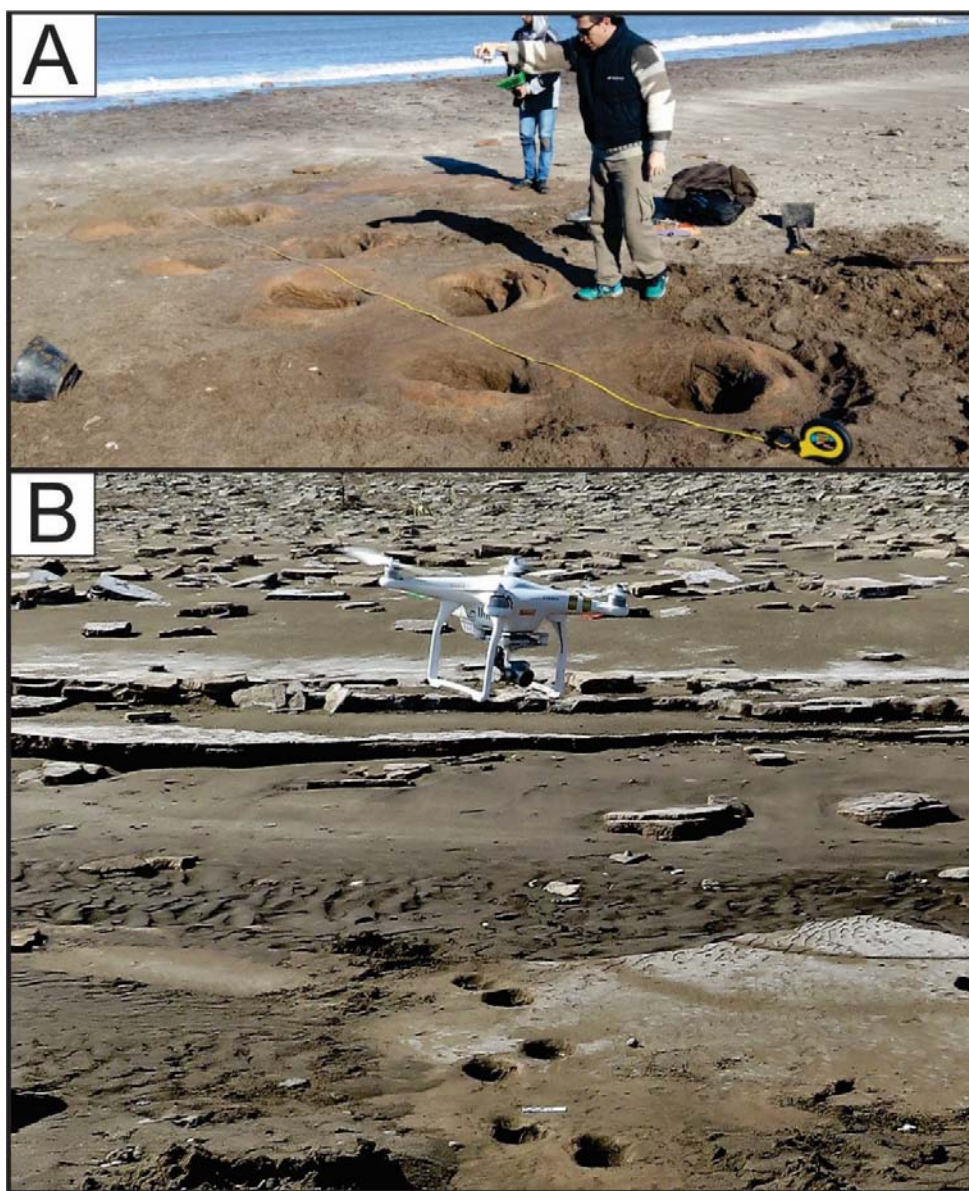
Figura. 2.7. Toma de fotos para fotogrametría. A. Utilizando una cámara fotográfica manual. B. Empleo del drone Phantom 3 Professional para fotos con vistas panorámicas y de diferentes ángulos.
