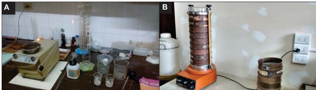
Figura 2.19. Preparación de muestras para análisis por difracción de rayos X. A. Balanza digital, probeta y vasos de precipitado. B. Tamiz empleado para separar la fracción < 0,062 mm.
