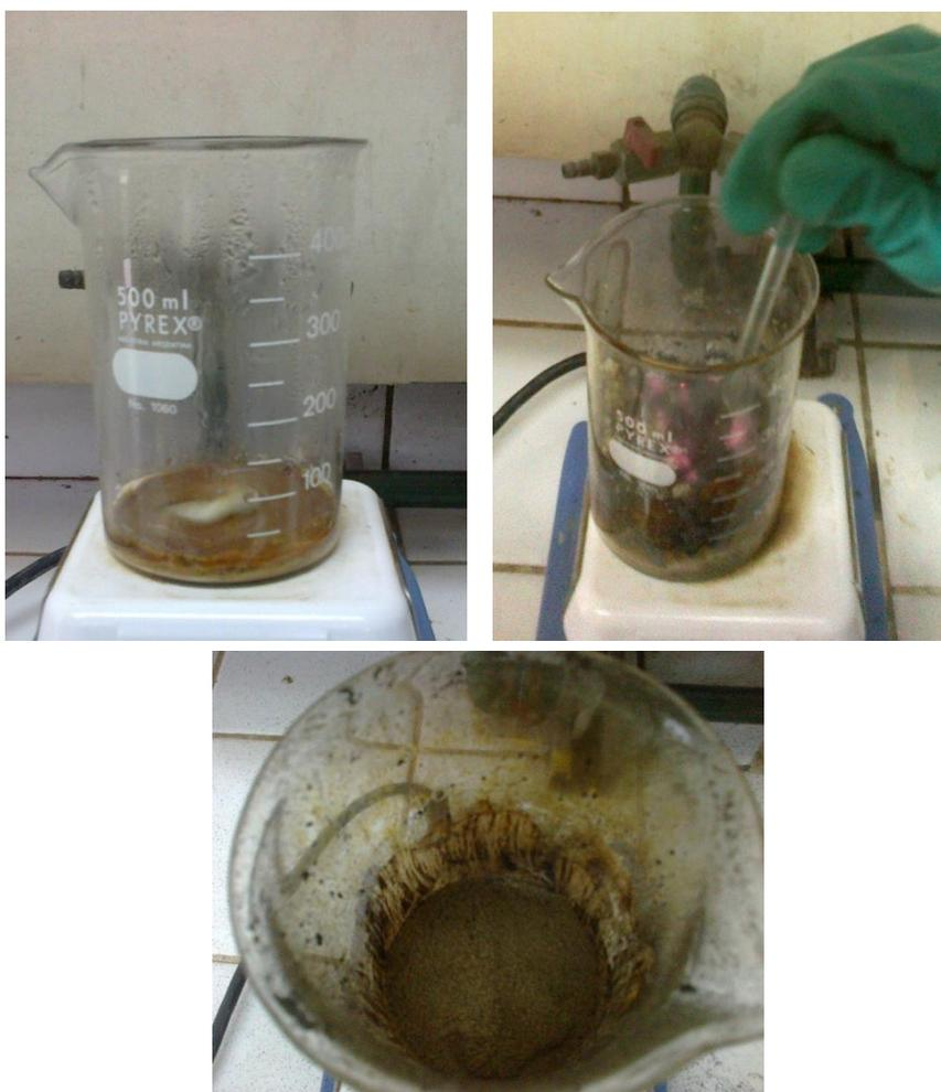
Figura 2.6- Fotografías de la síntesis de  $\text{CeO}_2\text{-C}$ .
