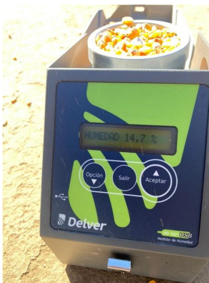
Figura 15: Humedímetro con el respectivo valor de humedad del maíz
