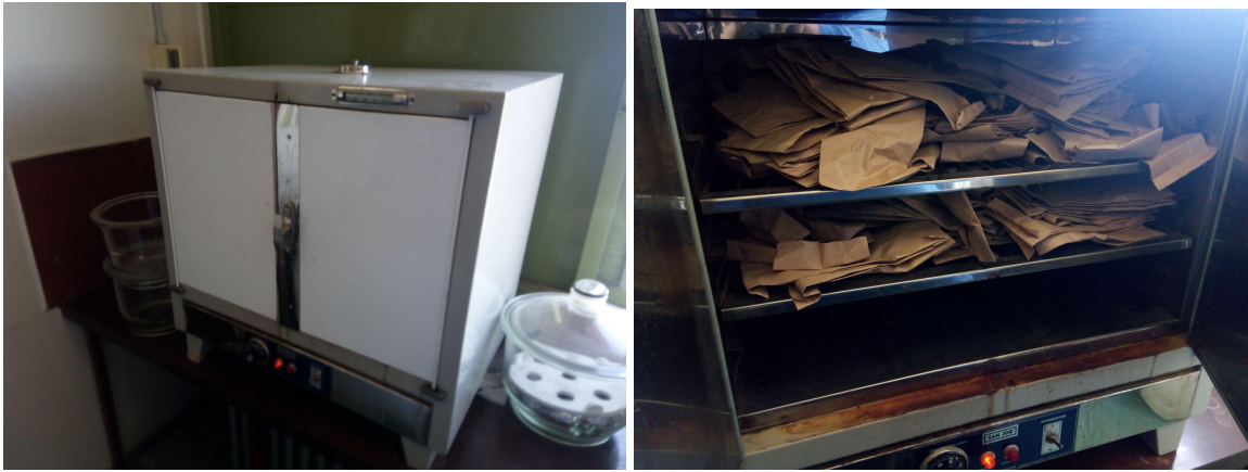
Figura 4 H (izquierda): Estufa utilizada para la obtención del peso seco de la biomasa cosechada. Figura 4 I (derecha): Distribución de las bolsas con el material vegetal en la estufa.
