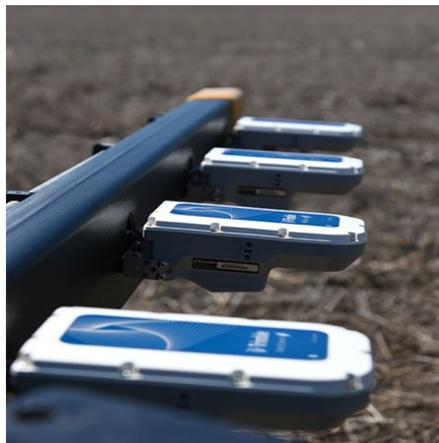
Figura 21. Sensores de lectura NDVI instalados sobre botalón (imagen ilustrativa obtenida <https://maquinac.com>)
