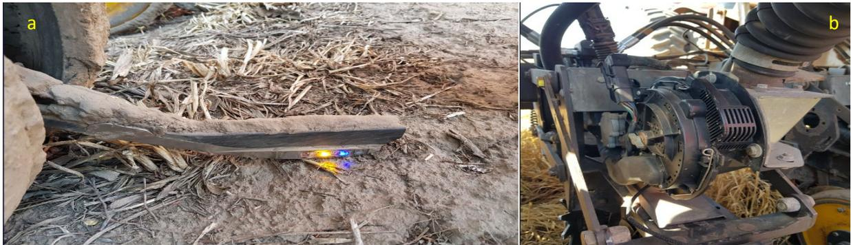
Figura 20. Vista de un sensor *SmartFirmer* (a) y de un dosificador variable (b), instalados en la sembradora de grano grueso marca ERCA.
