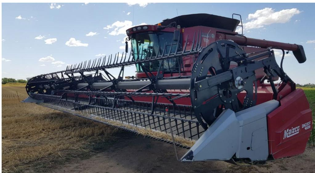
Figura 18. Cosechadora CASE con sistema de recolección draper.
