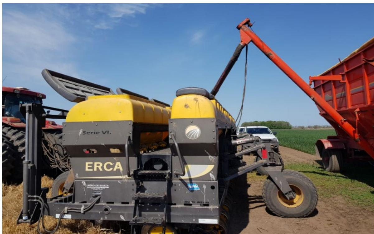
Figura 11, Sembradora ERCA de grano grueso con sistema variable Precision Planting.
