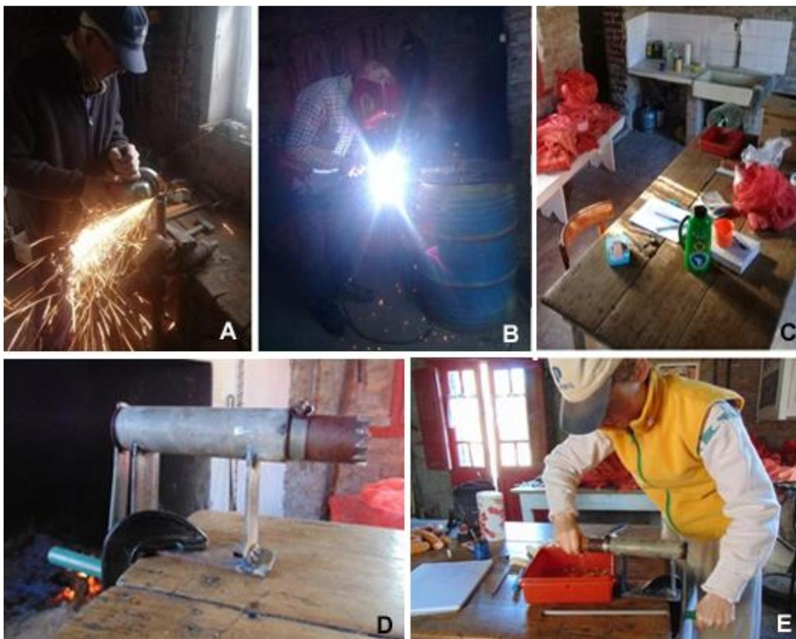
Figura 18. A- B) Corte y soldado de las piezas de la trilladora de espigas. C) Lugar de trabajo. D) Trilladora manual de espigas de maíz. E) Proceso de trillado de espigas.
