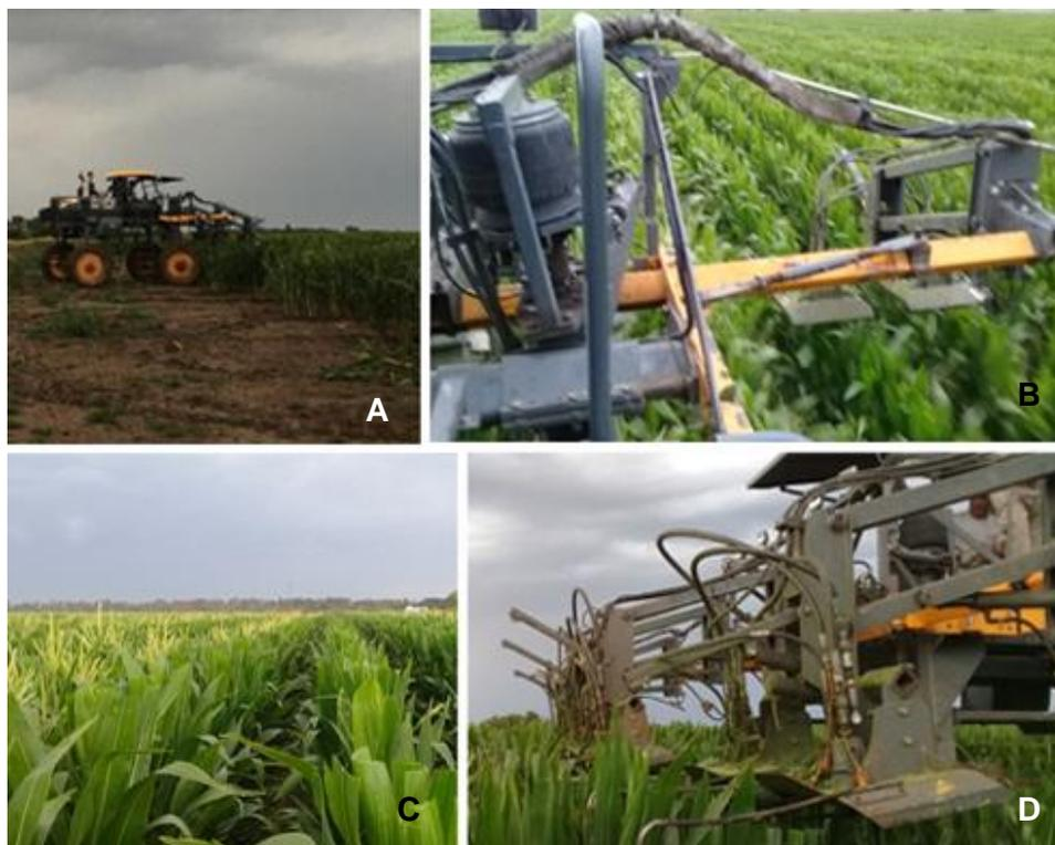
Figura 20. Despanojadora autopropulsada (HAGIE). A) Vista de la maquina entrando al lote. B) Vista desde arriba de la despanojadora al momento de trabajo. C) Plantas luego del corte. D) Vista lateral de los cuerpos cortadores.
