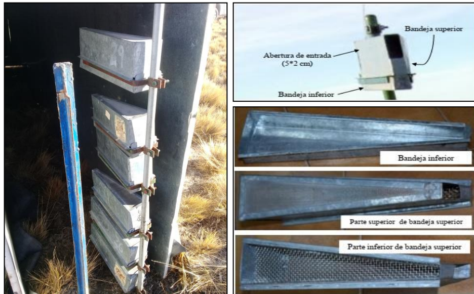
Figura 12. Colectores BSNE. A la izquierda, mástil con colectores colocados a la salida del túnel de viento. A la derecha, en la foto de arriba se detalla el exterior del colector y en la foto de abajo, se detalla el interior del colector BSNE.
