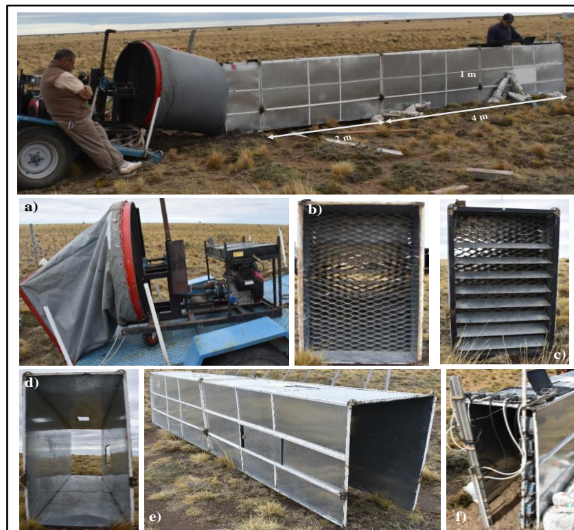
Figura 11. Componentes del túnel de viento portátil. a) Motor sobre el carro y segmento que lleva la hélice, b) placa cribada, c) chapas deflectoras, d) tramo del túnel con piso, e) zona de medición y f) salida del túnel con colectores BSNE y anemómetros.
