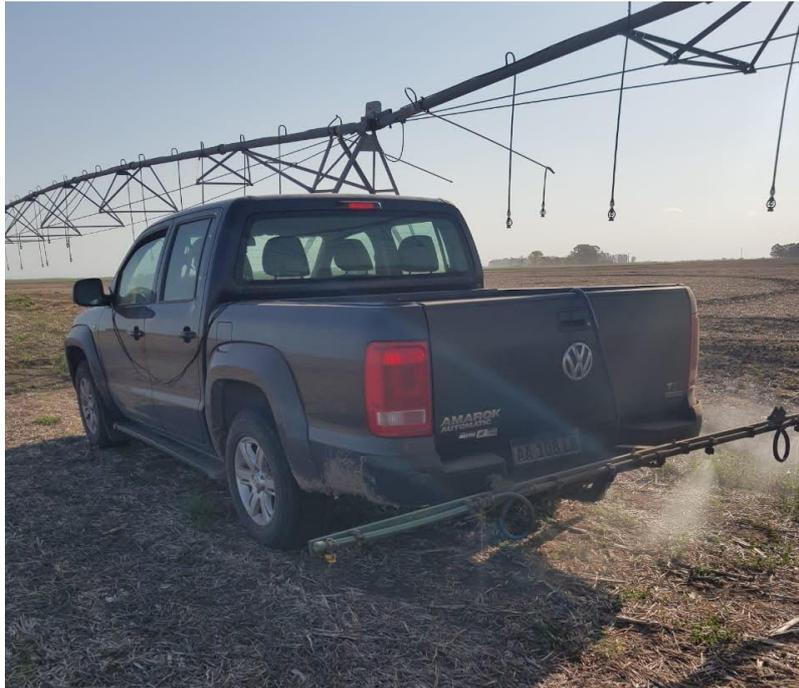
**Figura 10.** Vista del botalón móvil utilizado para controlar malezas en los sitios de difícil acceso para la pulverizadora.
