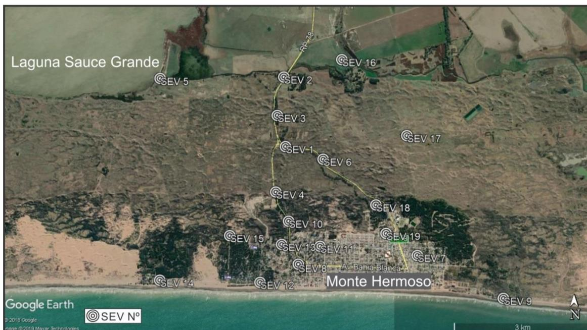
Figura 6.3.2.2.1: Sondeos eléctricos verticales realizados por S.A.S.B.A (1976) en Monte Hermoso.
