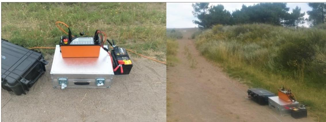
Figura 2.5.4.3: Resistivímetro ARES.
