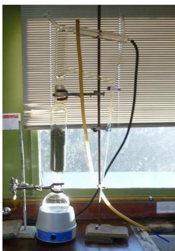
**Figura 12.** Fotografía del equipamiento utilizado para la destilación de las muestras.
