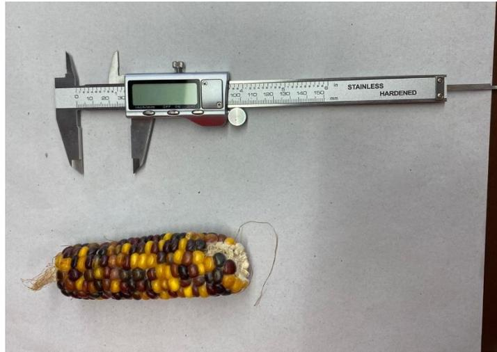
Figura 10. Calibre digital con el cual se midió el diámetro de las espigas
