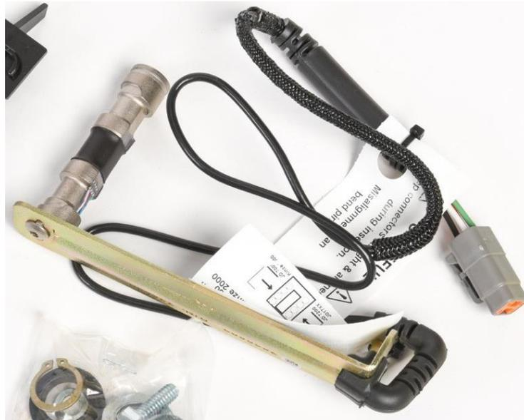
Figura 17 – Celda de carga utilizada para medir fuerza aplicada al suelo
