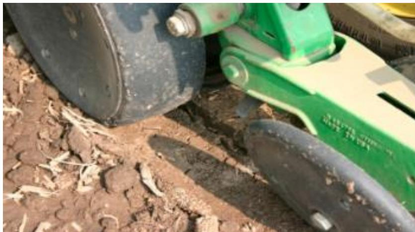
*Figura 6 – Exceso de carga en el cuerpo de siembra, generando compactación de los laterales del surco
