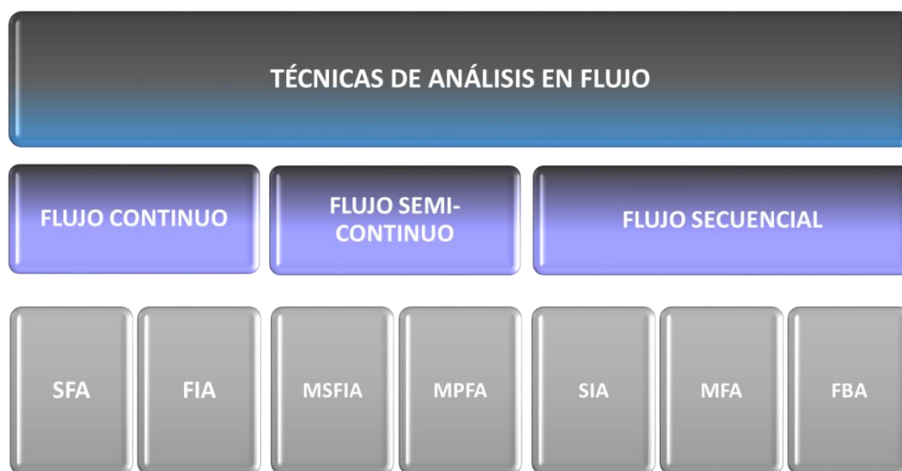
Figura 1.7. Clasificación de las Técnicas de Análisis en Flujo. SFA: Análisis en flujo segmentado; FIA: Análisis por Inyección en Flujo; MSFIA: Análisis por Inyección en Flujo
