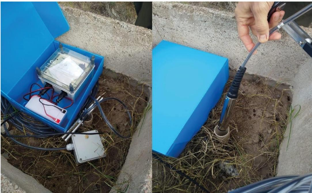
Foto 2.3.2.c. Fotografía de sonda freaticométrica de registro continuo (LF-10) instalada en pozo freaticométrico en el sitio experimental.
