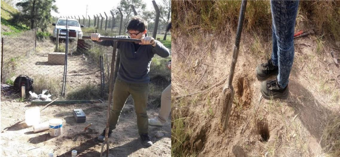
Foto 2.3.1.1. Muestreo destructivo de la ZNS mediante pala hélix.
