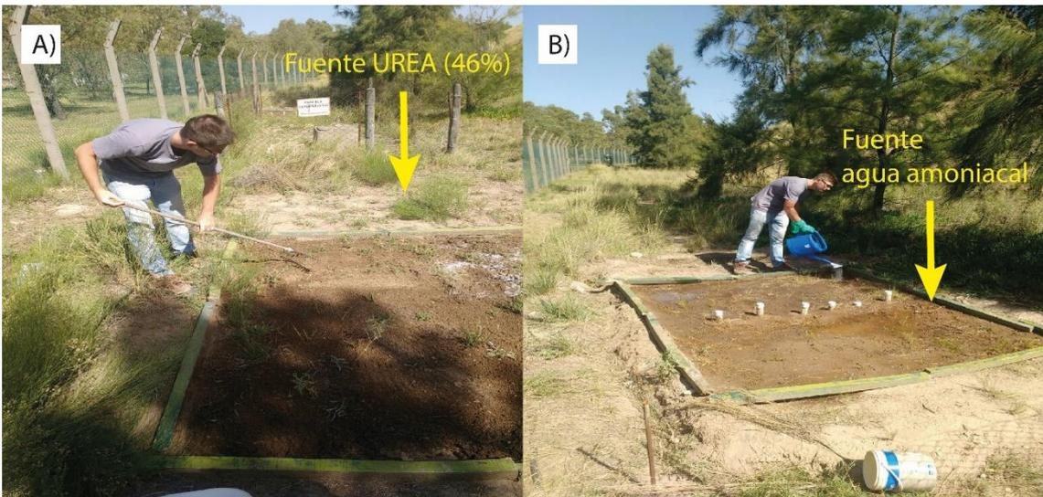
Foto 2.3.5.a. Vertido de fuentes de nitrógeno en los ensayos de transporte de campo. A) Fuente urea. B) Fuente nitrógeno amoniacal.
