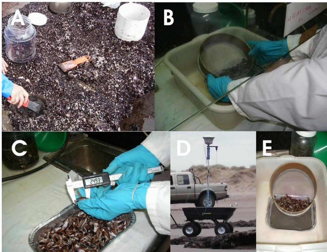
**Figura 2.2.** Muestreo (A); procesamiento de la muestra del mejillinar en laboratorio (B); medición de tallas de *Brachidontes rodriguezii* (C); relevamiento del perfil topográfico con GPS diferencial Radian IS Sokkia (D); separación de sedimentos del mejillinar con tamiz de 500 micras (E).
