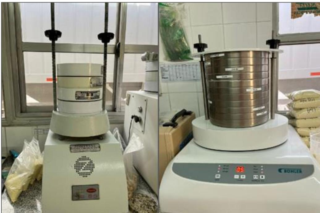
*Imagen 31. Vibrador mecánico con mallas tamices.*
