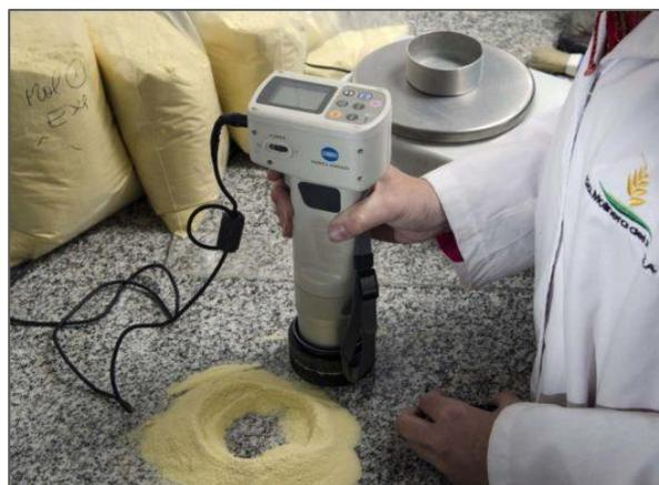
Imagen 30. Colorímetro y resultados de colorimetría obtenidos en el laboratorio. L 84,27; a -2,38 y b 22,70.
