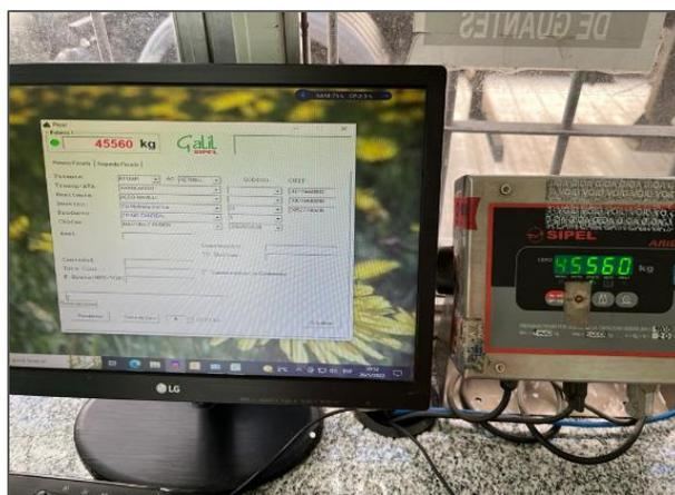
Imagen 10. Monitor de balanza de camiones
