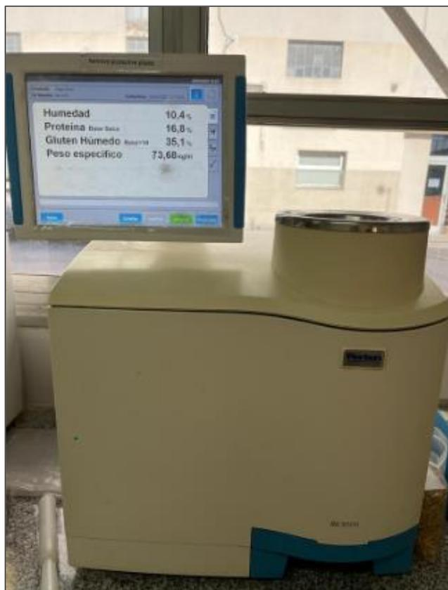
*Imagen 28. Inframatic de CMS mostrando parámetros de calidad de una muestra de trigo candeal. Humedad 10,4%, Proteína (b s) 16,8%, Gluten húmedo 35,1% y peso específico 73,68.*
